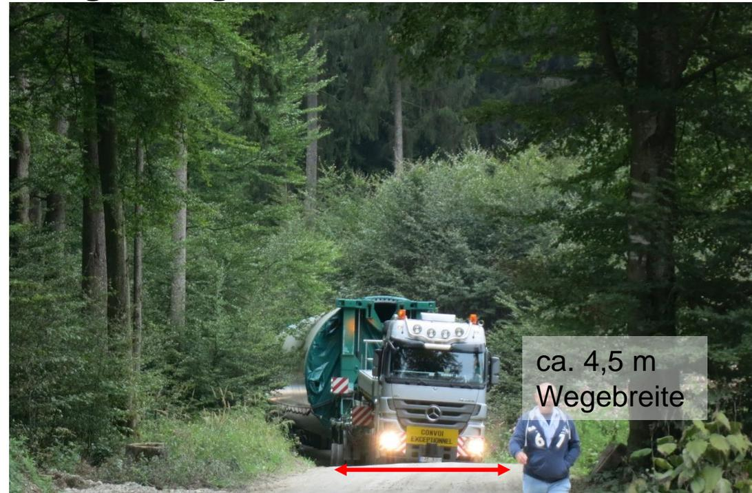
Anlieferung einer Großkomponente (Stahlurmteil) im Windpark Berg
