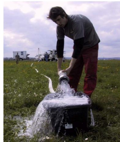
Der Pumpversuch zeigt, wie ergiebig ein Brunnen ist und welche Pumpe später für den Wärmepumpenbetrieb eingebaut werden sollte.
