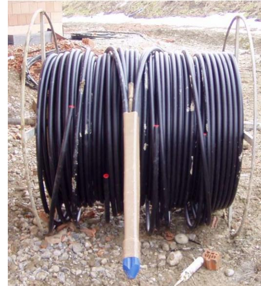
Einbaufertige Erdsonde aus einem PE-Doppel-U-Rohr.
