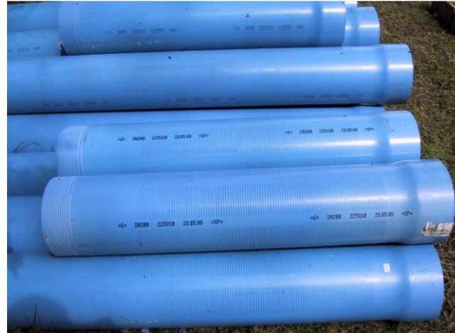
Brunnenausbaumaterial aus PVC (Filter- und Vollrohre). Die Brunnenrohre haben meist einen Durchmesser zwischen 125 – 200 mm.
