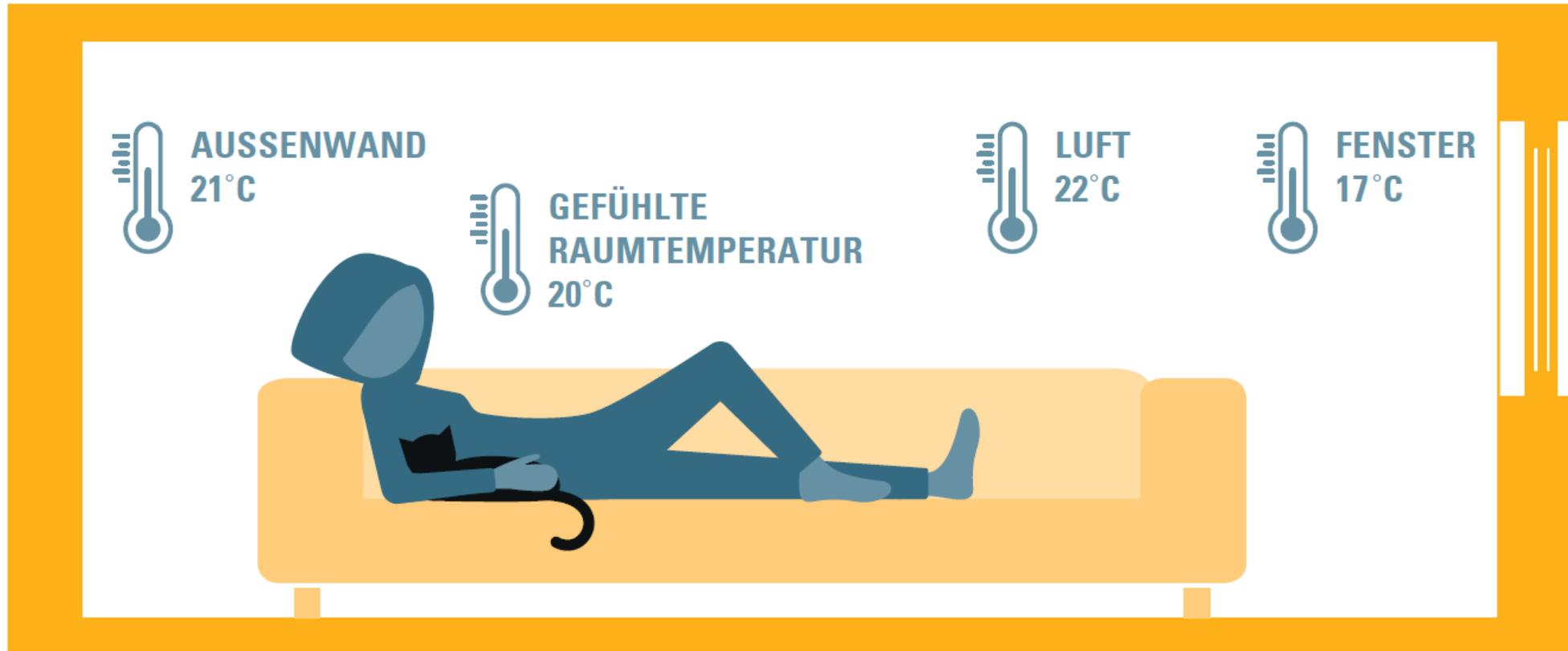
Gut gedämmte Wände und Fenster sind ein Garant für hohen Komfort. Die gefühlte Raumtemperatur ergibt sich aus den Temperaturen von Wänden, Fenstern und der Luft.
