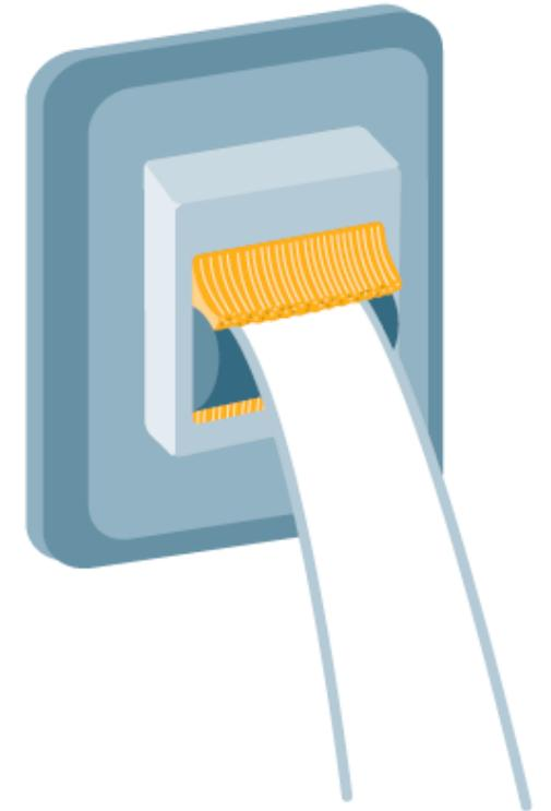
Zugluft an den Rollladen-Banddurchlässen vermeiden Sie mit Bürstensystemen.
